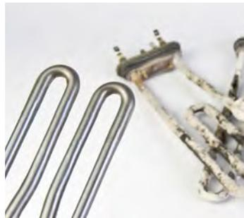
Por otro lado ¿Sabía usted que una capa de 1 mm en el calentador de agua, puede aumentar en un 10% el consumo de energía?
